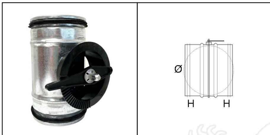
Serranda a farfalla in lamiera d'acciaio zincato completa di comando manuale con guarnizione in gomma a tenuta per l'innesto nei canali spiralati. Necessaria per la parzializzazione del passaggio dell'aria.
