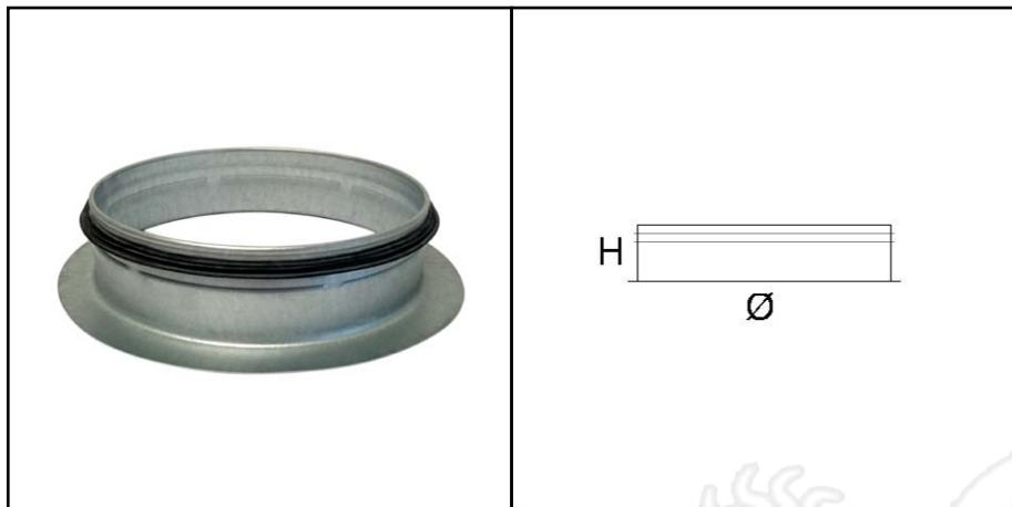
Manicotto maschio cartellato in lamiera d'acciaio zincato con guarnizione in gomma per l'innesto nei canali spiralati. Necessario per il raccordo dei canali circolari su canale a sezione rettangolare.
