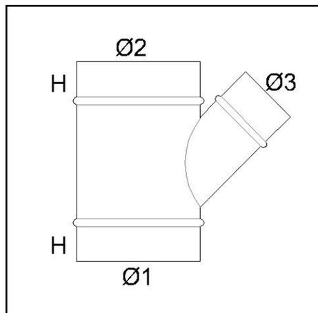
Innesto a tee conico con stacco a 45° in lamiera d'acciaio zincato, necessario per il raccordo di due canalizzazioni perpendicolari l'una con l'altra.
