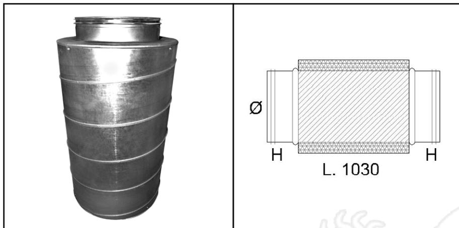
Silenziatore circolare dritto per impianti di aerazione costruito in lamiera d'acciaio zincato a doppia parete con interposta la lana di vetro dello spessore di 50 mm tra lo strato di lamiera esterno e quello di lamiera forata interno con l'imbocco completo di guarnizione in gomma a tenuta per l'innesto nei canali spiralati. Lunghezza std 1030 mm.
