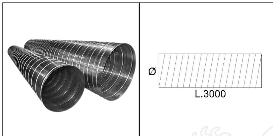
Condotto spiralato in lamiera d'acciaio zincato con graffatura a tenuta meccanica in materiale di classe di reazione al fuoco 0 (zero). I canali a partire dal Ø560 mm sono normalmente prodotti con nervatura di rinforzo per aumentare la rigidità del canale. La lunghezza standard da noi prodotta è di 3000 mm.
