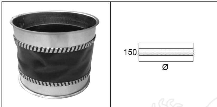
Giunto antivibrante in lamiera d'acciaio zincato e tela in neoprene resistente al calore fino a 100°C. Necessario per non trasmettere le vibrazioni prodotte dalle macchine alle canalizzazioni.
