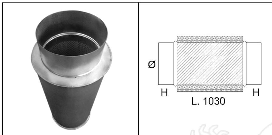
Silenziatore circolare lineare per impianti di aerazione costruito in lamiera d'acciaio zincato a doppia parete con interposta la lana di vetro dello spessore di 50 mm tra lo strato di lamiera esterno e quello di lamiera forata interno. La lunghezza standard del silenziatore è di 1030 mm.
